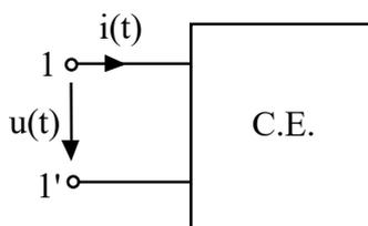
Figura 1. Representación de un dipolo.
