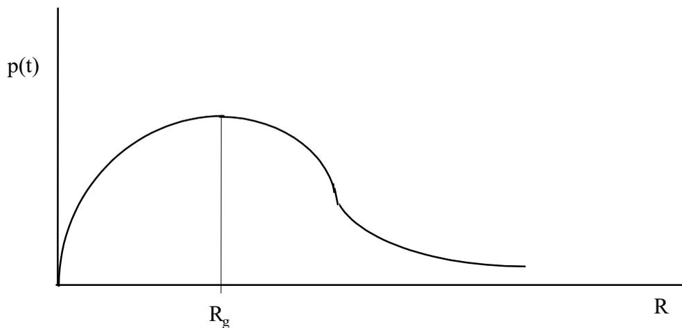
Figura 9. Representación de la potencia de una fuente de tensión real.
