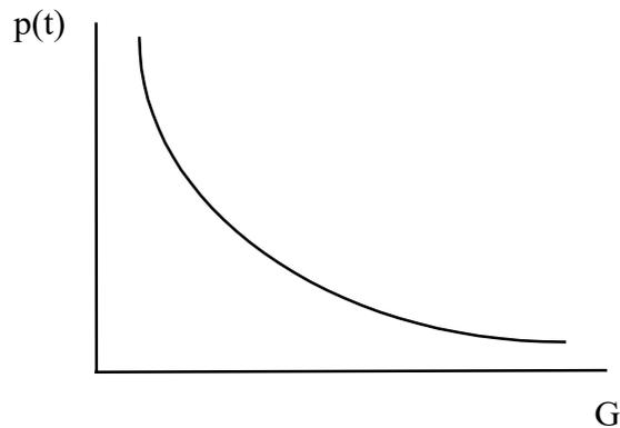
Figura 7. Representación de la potencia en una fuente de intensidad.
