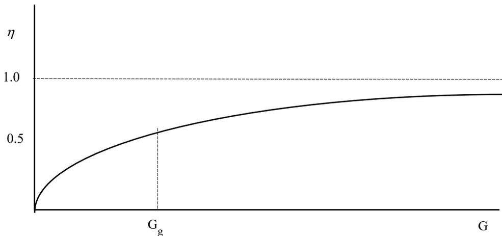
Figura 13. Representación del rendimiento de una fuente de intensidad real.
