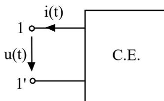
Figura 2. Representación de un dipolo.
