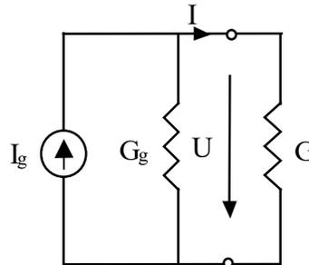
Figura 11. Referencias tomadas en una fuente de intensidad real.
