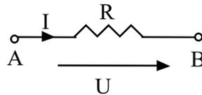
Figura 3. Referencias tomadas en una resistencia.
