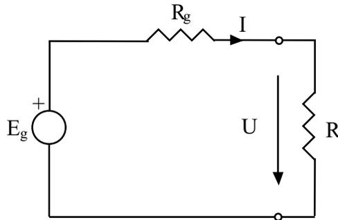
Figura 8. Referencias tomadas en una fuente de tensión real.
