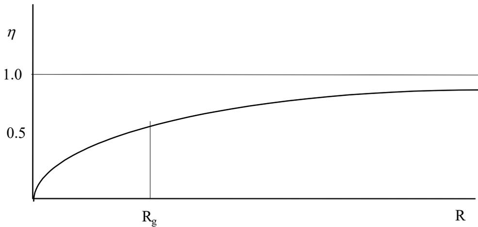
Figura 10. Representación del rendimiento de una fuente de tensión real.
