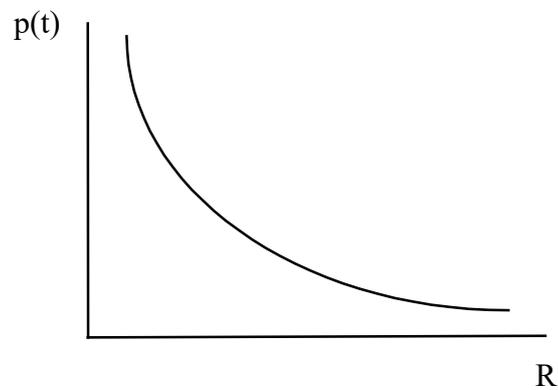
Figura 5. Representación de la potencia en una fuente de tensión.
