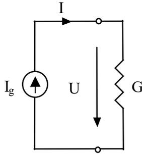
Figura 6. Referencias tomadas en una fuente de intensidad.
