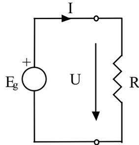
Figura 4. Referencias tomadas en una fuente de tensión.
